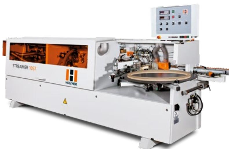
Комплексная обработка вкл. обработку углов по копиру на станке STREAMER 1057 XL с стремя узлами последующей обработки.
